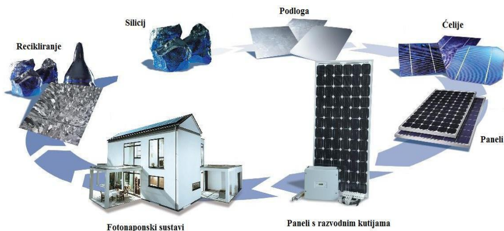
Slika 4.8. Shema procesa recikliranja fotonaponskih panela na bazi silicija [17]
