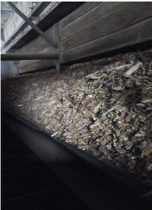
Slika 3.5. Sječka pada na traku
