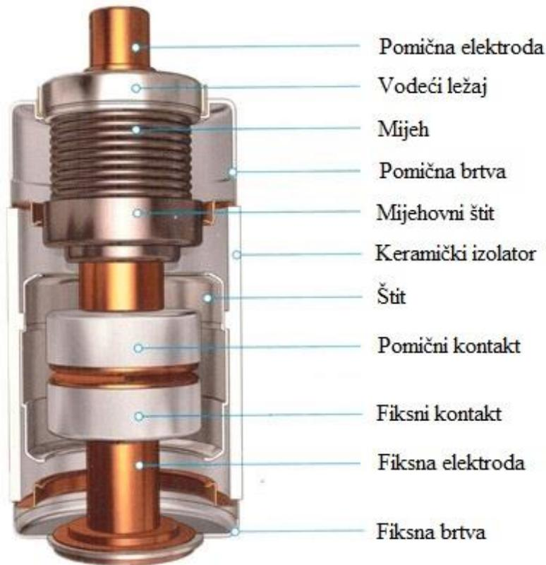
Sl.2.4. Presjek i komponente vakuumskog prekidača
