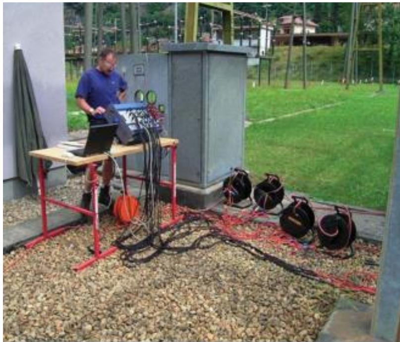
Sl.4.4. Prekidač spojen za ispitivanje
