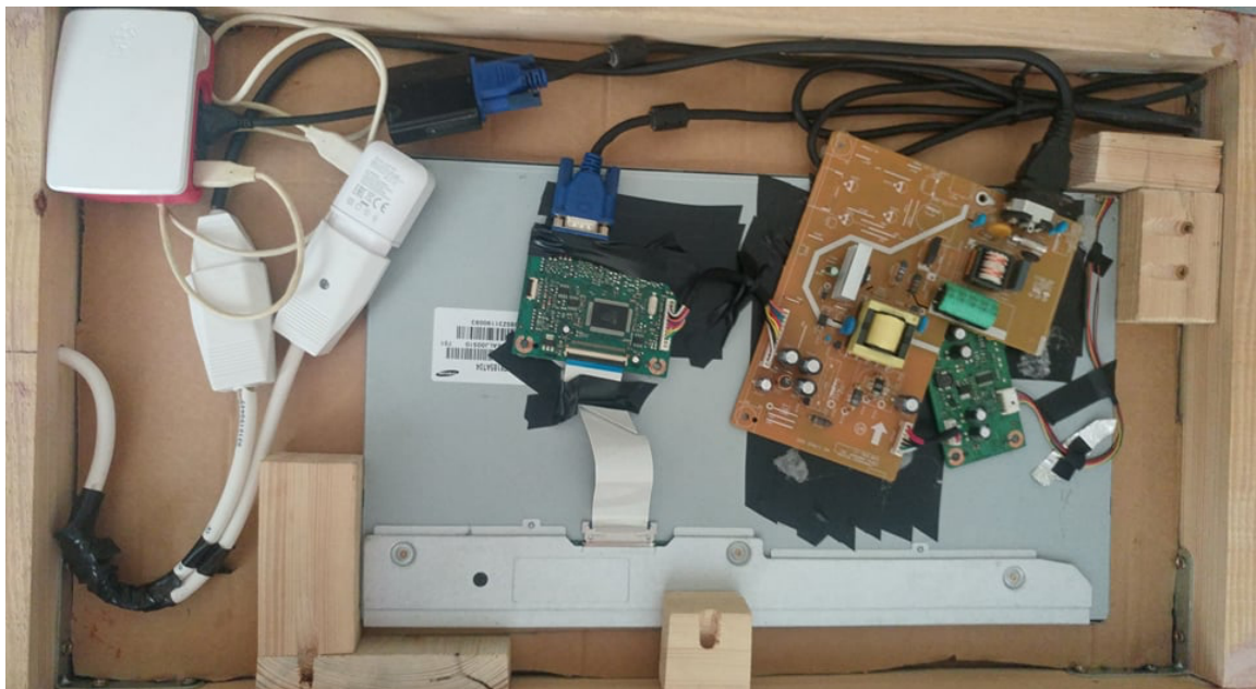
Slika 4.8. Elektroničke komponente unutar drvenog kućišta
