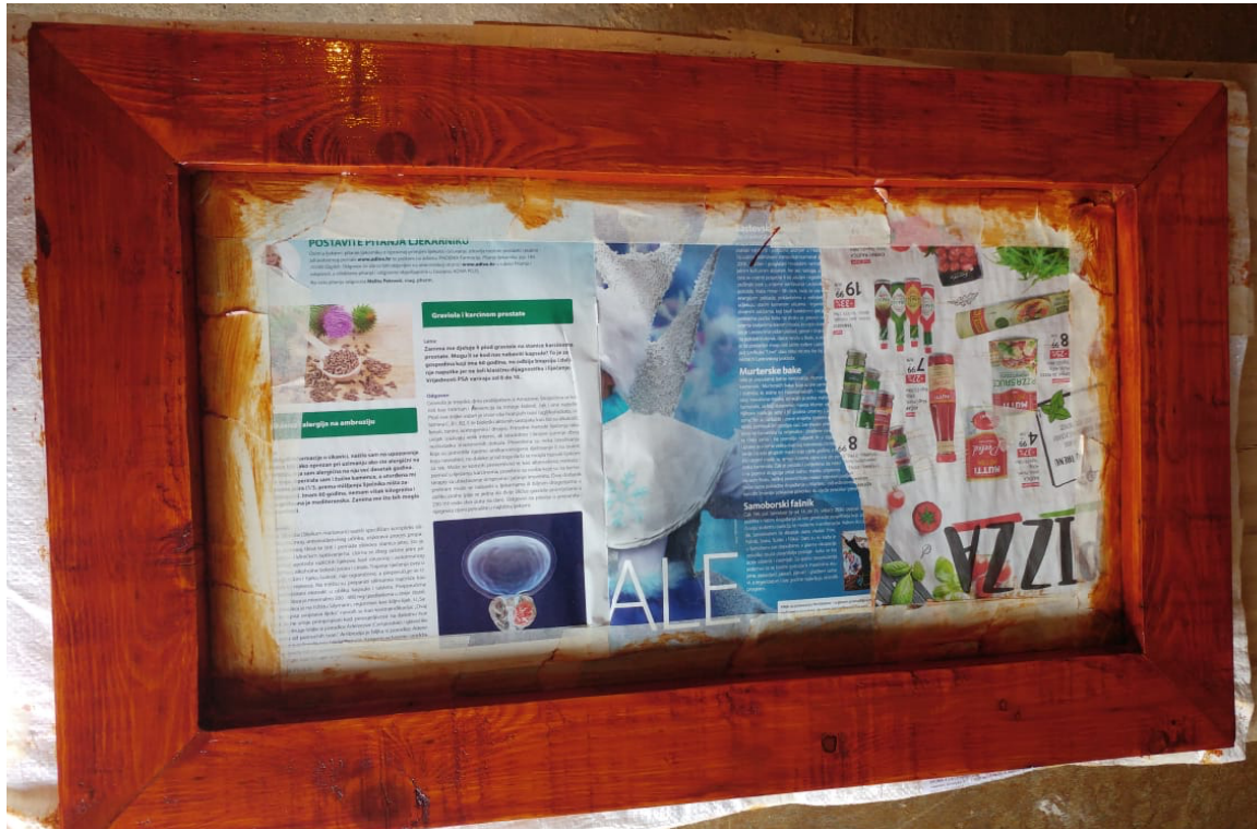
Slika 4.7. Drveni okvir pametnog zrcala
