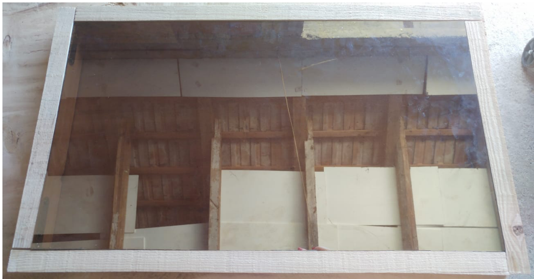
Slika 4.1. Prikaz prednjeg dijela okvira - akrilno dvosmjerno zrcalo
