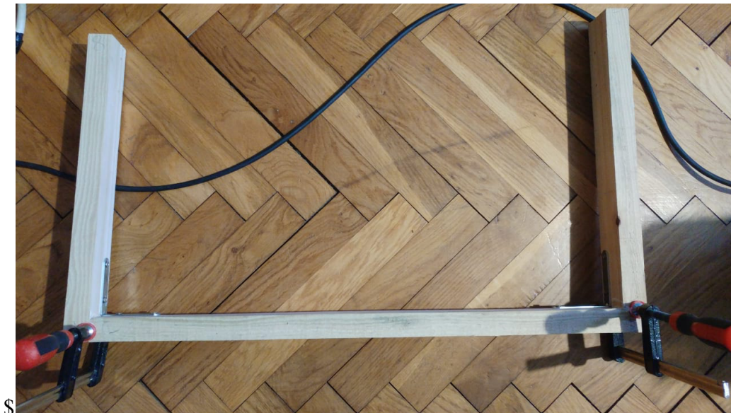
Slika 4.5. Učvršćivanje drvenog okvira
