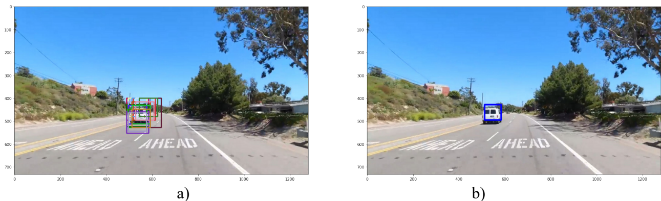
Slika 3.10. NMS algoritam: a) prije primjene, b) nakon primjene
