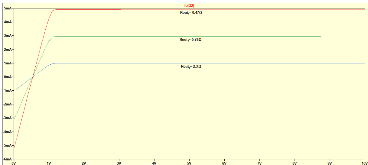
Slika 21. Grafički prikaz ovisnosti izlazne struje o naponu s prikazanim pripadnim vrijednostima otpora – rezultat simulacije temeljen na električnoj shemi strujnog zrcala emitorske degeneracije sa slike 20
