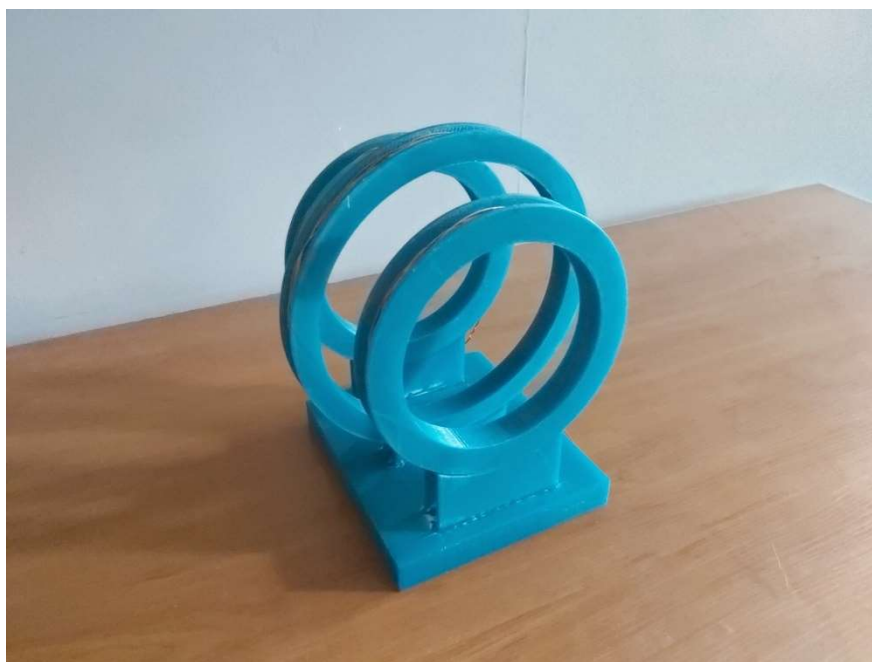
Slika 4.20 – Fizička maketa Maxwellovog sustava svitaka
