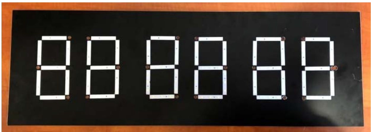
Slika 4.1. LED trakice spojene na ploču
