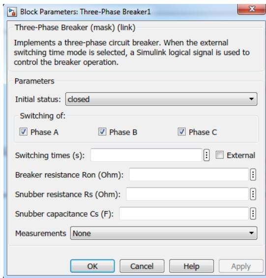
**Slika 5.13.** Blok za parametrisanje SN prekidača
