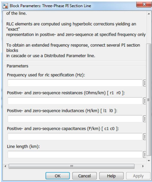
**Slika 5.8.** Blok za parametrisiranje modela energetskog trofaznog voda
