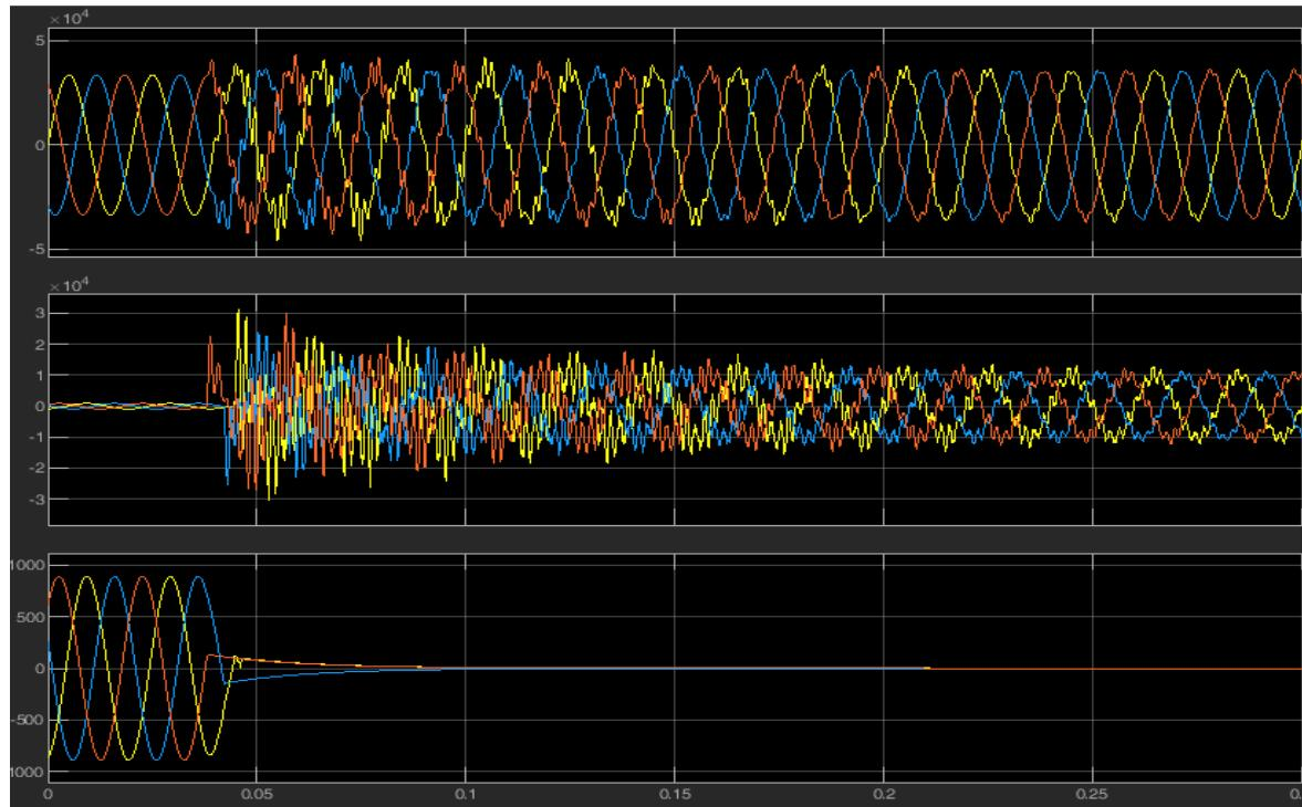
**Slika 6.2.** Snimljeni valni oblici primarnog napona i sekundarnog napona transformatora, te napona na teretu za vrijeme isklapanja prekidača  $t = 0,035$  s
