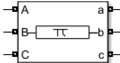
**Slika 5.6.** Model energetskog voda u Matlab – SimPowerSystems
