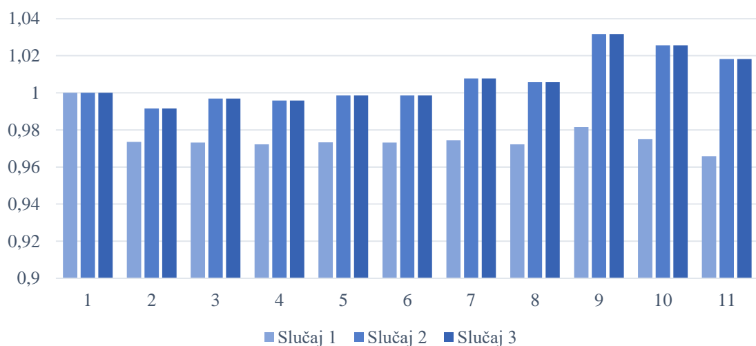
Slika 5.22. Jedinične vrijednosti (p.u.) napona sabirnica 1 – 11 u 3 simulirana slučaja za maksimalno opterećenje (u 21 sat)
