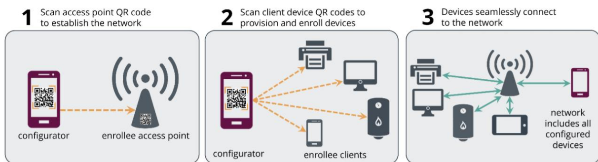
Slika 3.3: Wi-Fi Easy Connect princip rada. [16]
