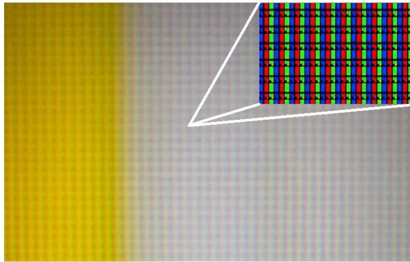
**Slika 3.4.** – Prikaz LCD-a pod povećalom.
