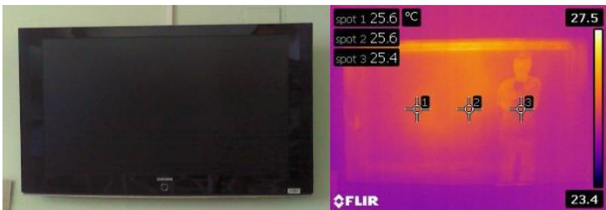
Slika 4.14. – Prikaz isključenog LCD LED televizora u vidljivom (lijevo) i infracrvenom (desno) spektru.
