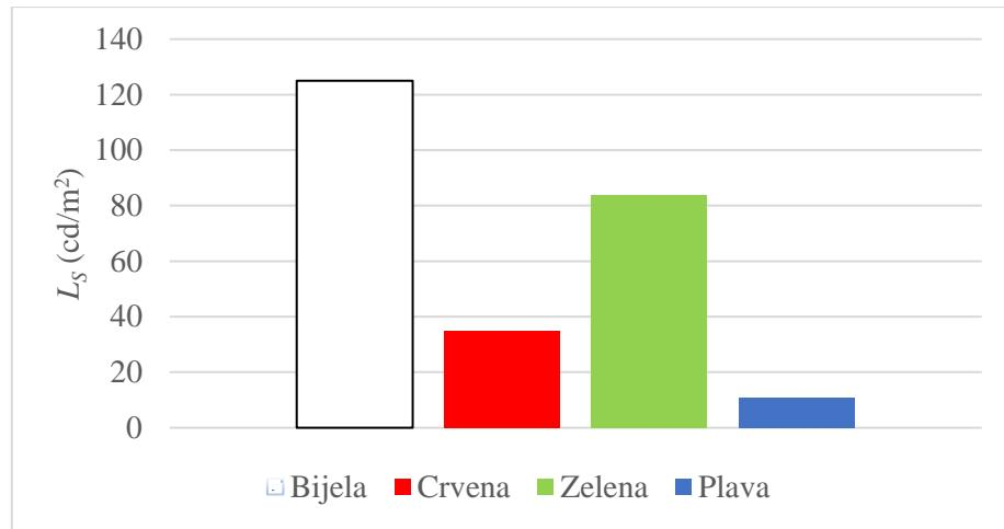
**Slika 5.8.** – Dijagram udjela primarnih boja testiranog LCD televizora.
