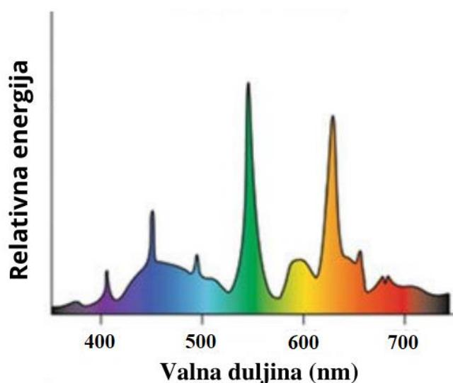
Slika 5.2. – Tipične vrijednosti spektralne osvjetljenosti za LCD zaslon, [34].
