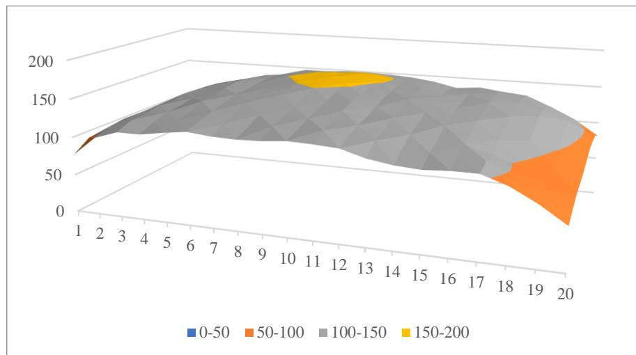
**Slika 5.6.** – 3D plošni grafikon raspodjele luminacije na 100% pozadinskog osvjetljenja pri mjeranjima testne slike šahovskog uzorka.
