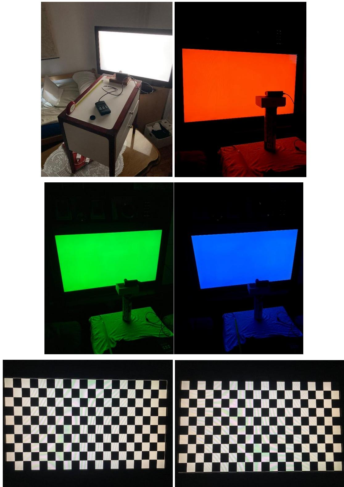
**Slika 5.3.** – Snimka eksperimentalnog postava i korištenih testnih slika neposredno prije fotometrijskog mjerena.
