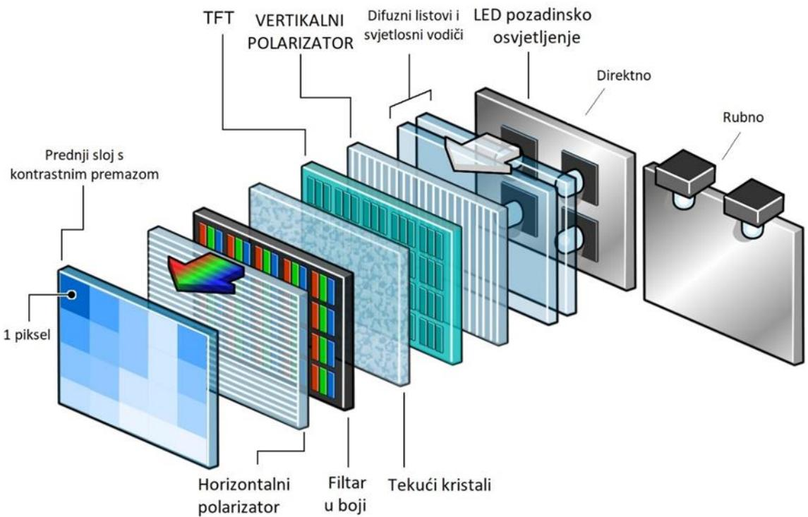
**Slika 3.6.** – Glavne komponente i princip rada LCD televizora, [12].
