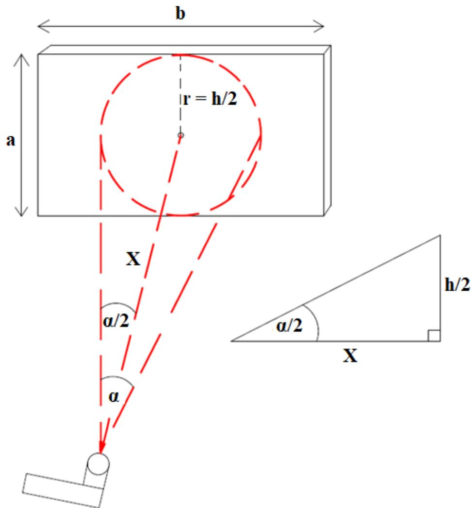
**Slika 5.10.** – Prikaz načina mjerjenja metodom fotometrije, obuhvatna mjerena površina (lijevo) te trigonometrijska skica izvoda formule za udaljenost (desno).
