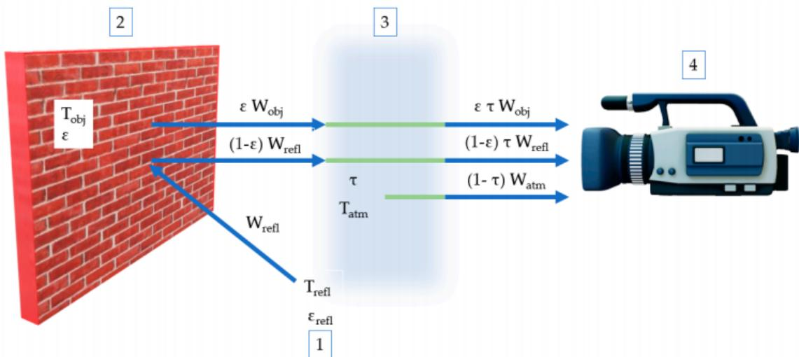
**Slika 4.1.** – Ilustracija mjerena infracrvenom termografijom, [21].
