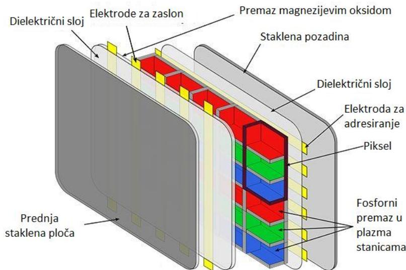
**Slika 3.2.** – Shematska konfiguracija matrične elektrode PDP-a, [4].
