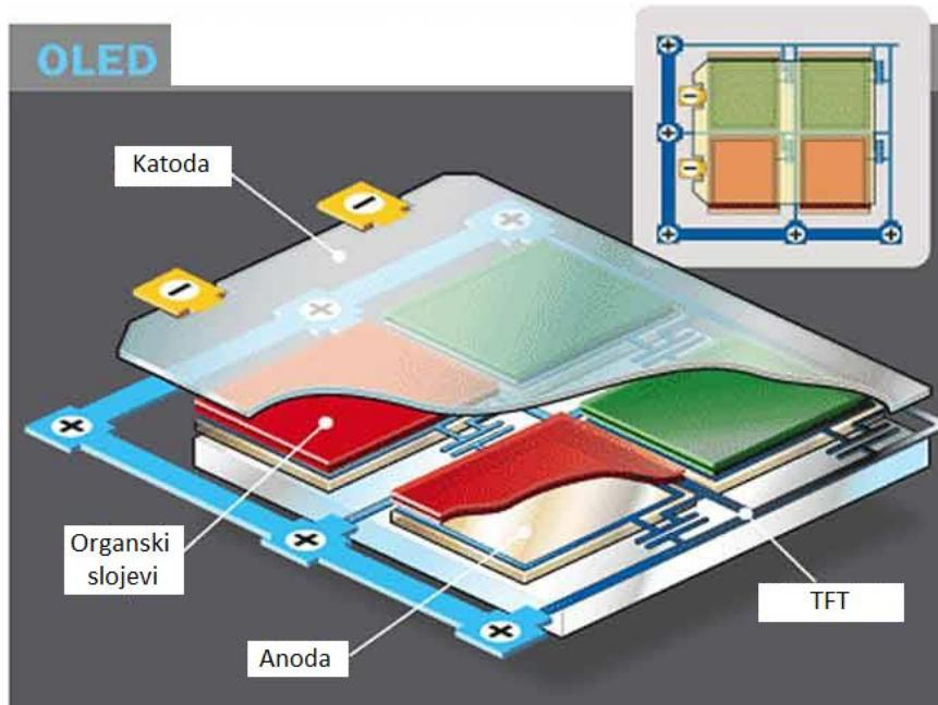
**Slika 3.3.** – Presjek tipičnog OLED panela, [6].
