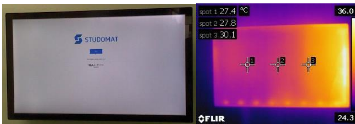
Slika 4.12. – Prikaz LCD LED televizora u vidljivom (lijevo) i infracrvenom (desno) spektru – rubno pozadinsko osvjetljenje.
