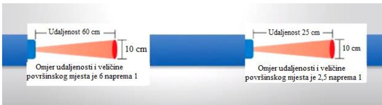
Slika 4.5. – Omjer udaljenosti između mjernog instrumenta i mjerenoj objekta, [25].
