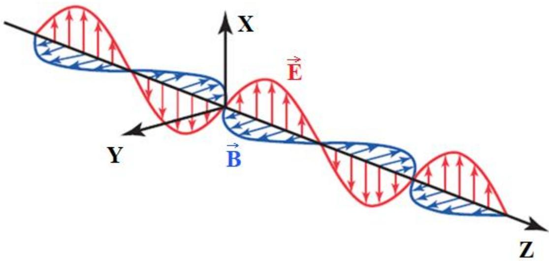
**Slika 3.10.** – Prikaz odnosa električnog polja i magnetske indukcije, [15].
