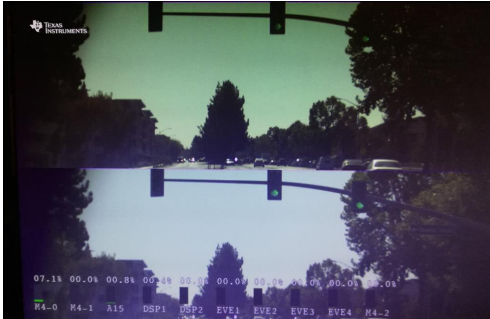
Slika 4.4. Prikaz detekcije svjetlosne prometne signalizacije u uvjetima niske osvjetljenosti.
