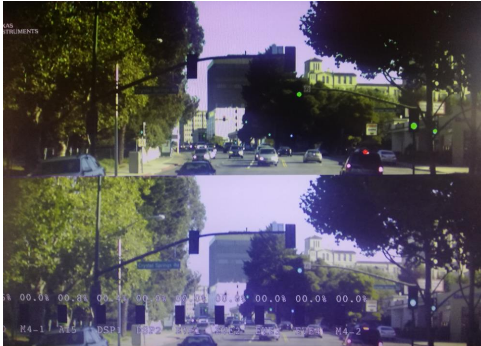
Slika 4.6. Prikaz utjecaja udaljenosti na detekciju svjetlosne prometne signalizacije.
