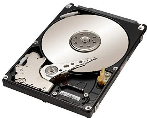
Slika 4.1. Unutrašnjost tvrdog diska
