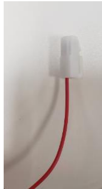
Slika 3.11 Konektor za paljenje na kontroleru HS4842580
