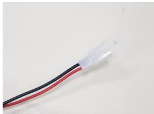
**Slika 3.17** Kontakti za dodatno napajanje kontrolera HS4842580
