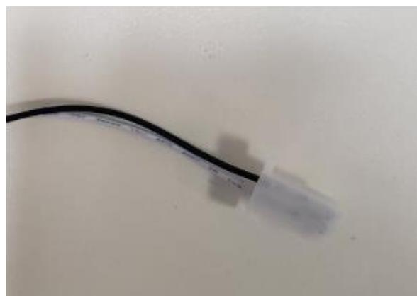
**Slika 3.20 Prikaz konektora za spajanje ručice kočnice HS4842580**
