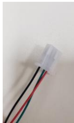
Slika 3.8 Kontakti za spajanje ručke gasa kontrolera HS4842580
