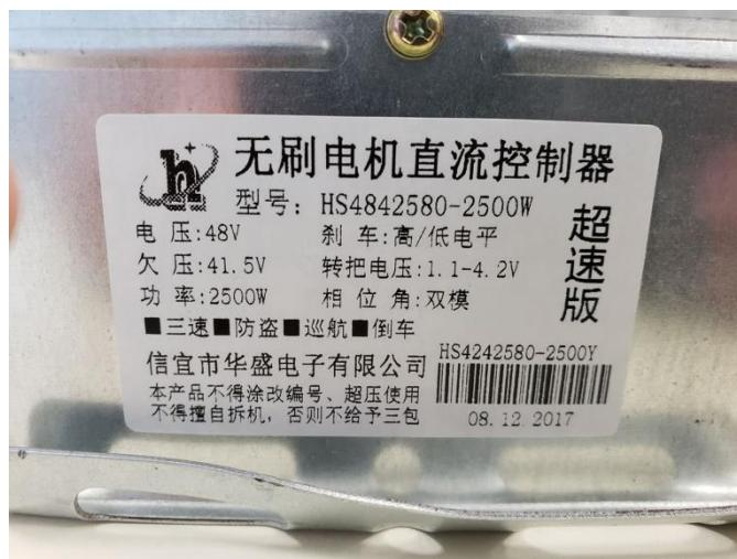
*Slika 3.1 Specifikacija kontrolera za istosmjerni elektromotor*
