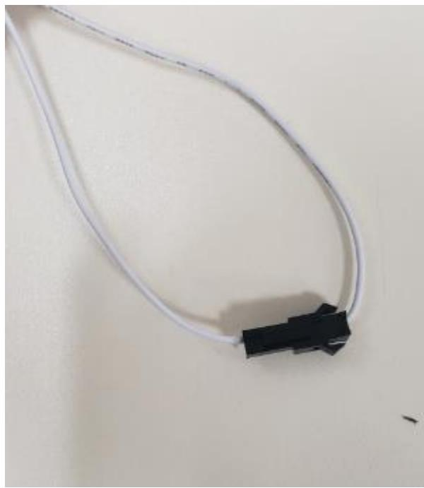
**Slika 3.18** Kratko spojeni kontakti za samoučenje kontrolera HS4842580
