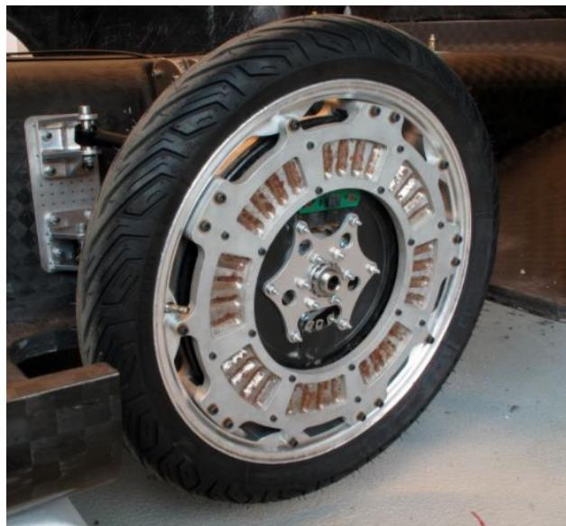
**Slika 2.19** Točak solarnog automobila [18]
