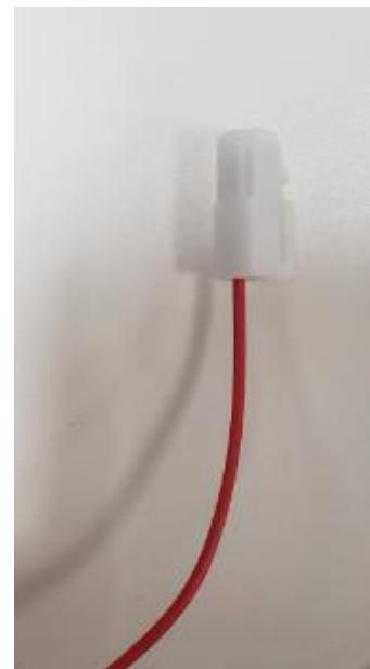
Slika 3.11 Konektor za paljenje na kontroleru HS4842580
