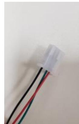
Slika 3.8 Kontakti za spajanje ručke gasa kontrolera HS4842580
