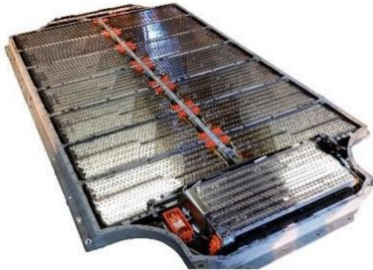
Slika 2.24 Arhitektura baterijskog sloja Tesla Model S [27]
