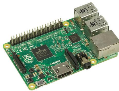
Slika 2.3. Industrijsko single-board računalo [5]
