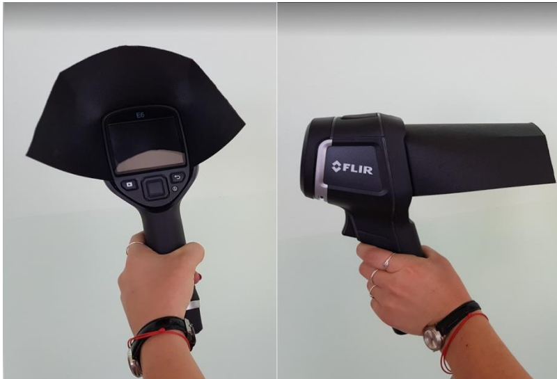
Slika 5.6. Zasjenjene zaslona kamere crnim papirom
