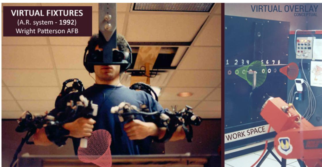
Slika 2.1. Prikaz sustava *Virtual Fixtures* [14]
