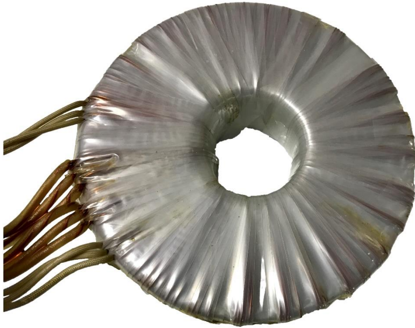
Slika 2.2. Jednofazni dvonamotni toroidni transformator korišten u istraživanju.
