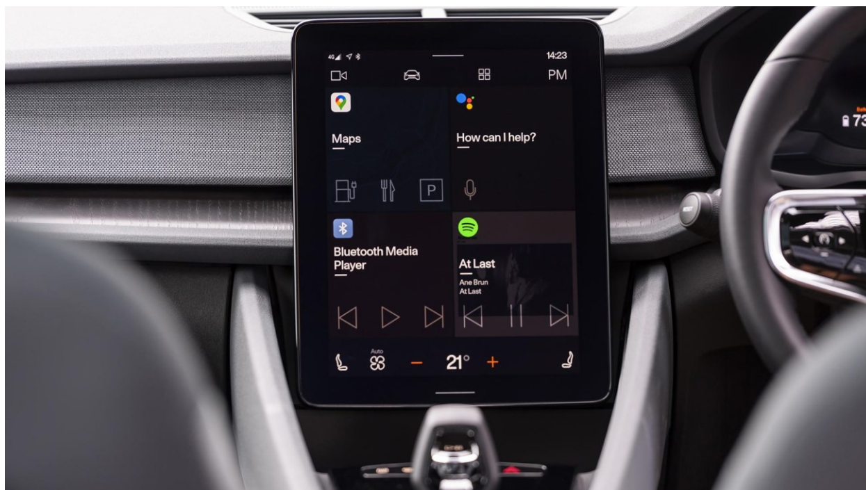
Slika 3.5. Izgled sučelja Android Automotive operacijskog sustava
