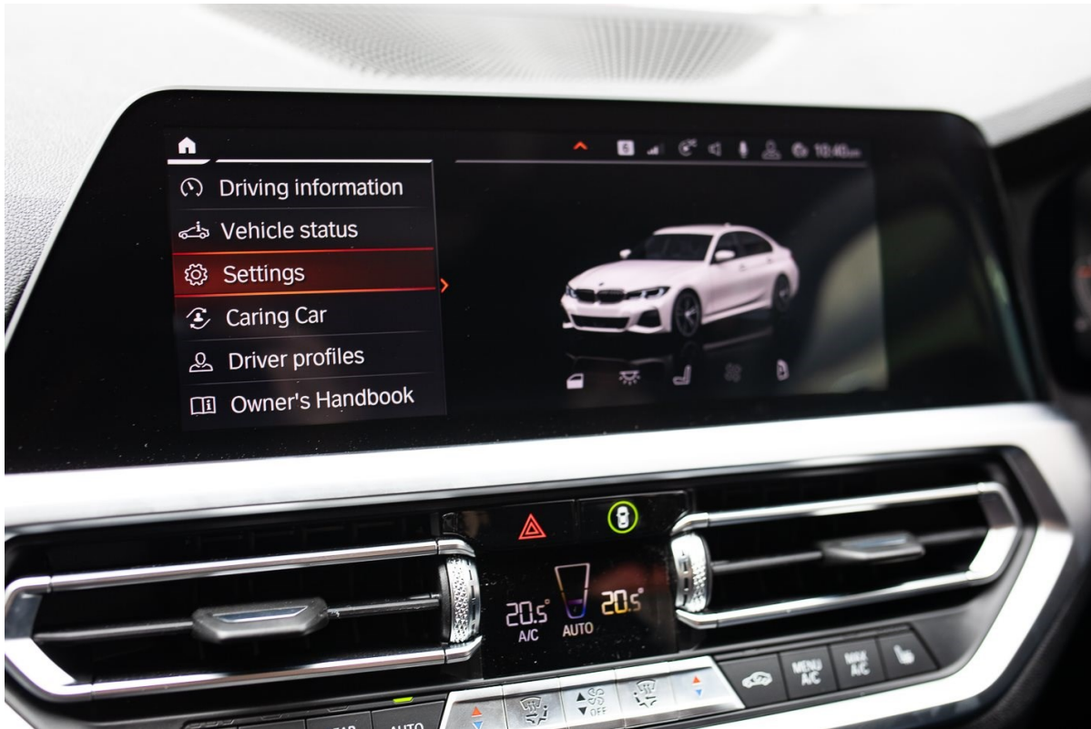
Slika 4.1. Izgled osnovanog sučelja iDrive informacijsko-zabavnog sustava
