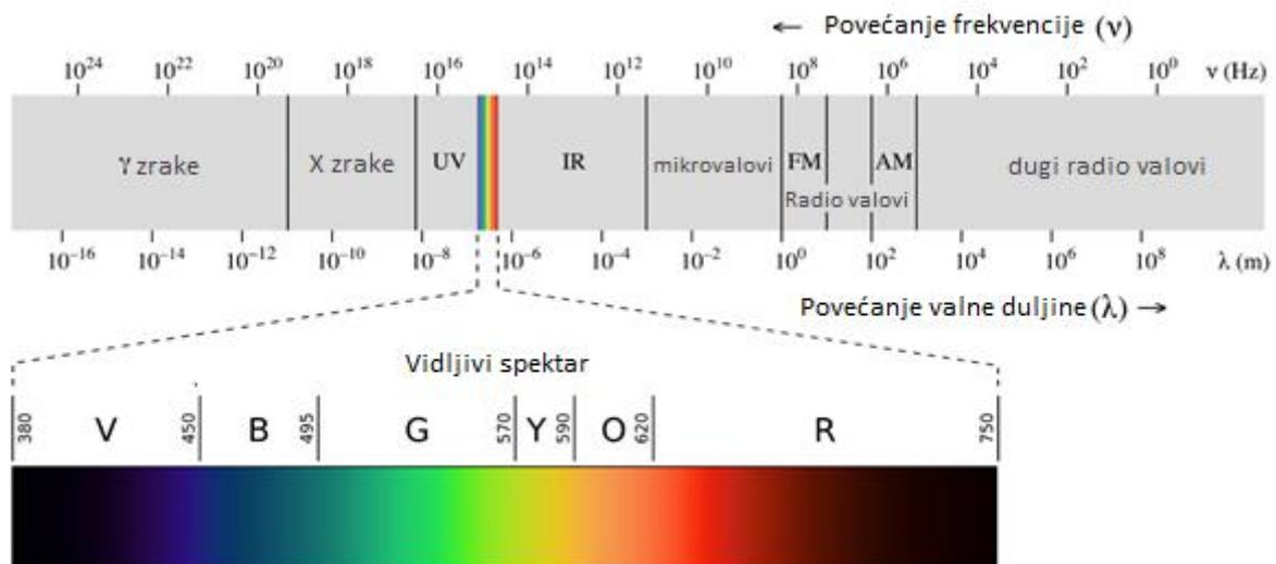
Slika 3.1. Elektromagnetski spektar[6]
