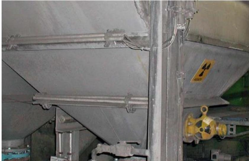
**Slika 6.3. Primjena radiometrijski uređaja na raznim oblicima spremnika[2]**
