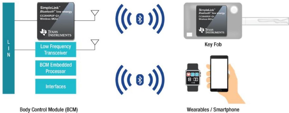
Slika 4.1. Blok dijagram pristupa automobilu korištenjem BLE aplikacije [25]
