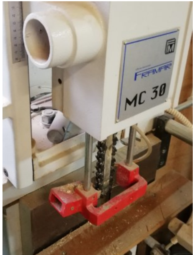
Slika 3.7. Radna površina i pila dubilice (fotografirano 18.4.2018.)
