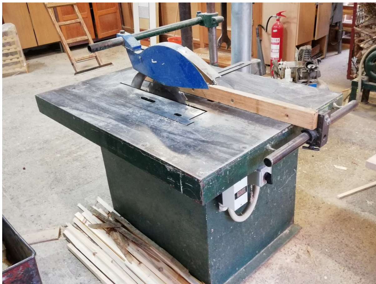
Slika 3.17. Kružna pila za uzdužno krojenje (fotografirano 18.4.2018.)
