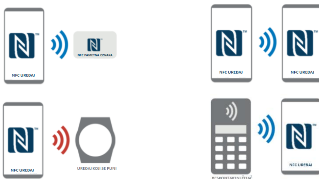
Sl. 3.2. Prikaz različitih načina rada NFC tehnologije [14].
