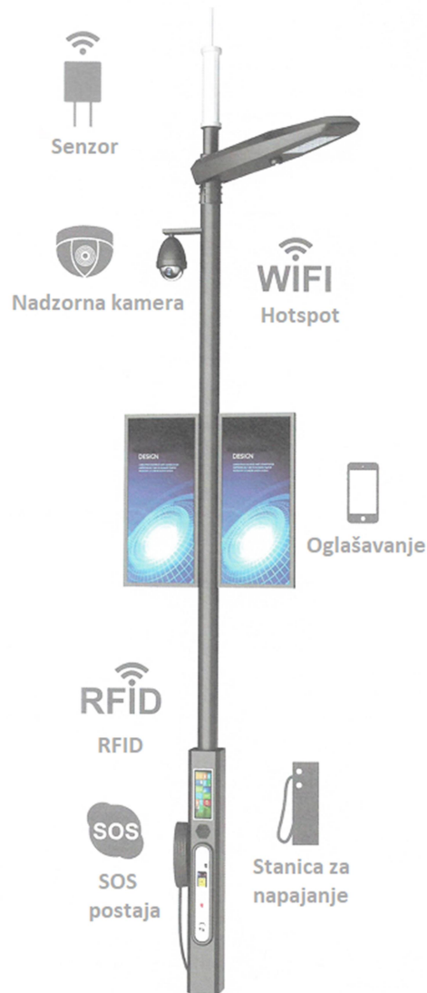
Slika 3.2 Prikaz multifunkcionalnog pametnog rasvjetnog stupa [40]
