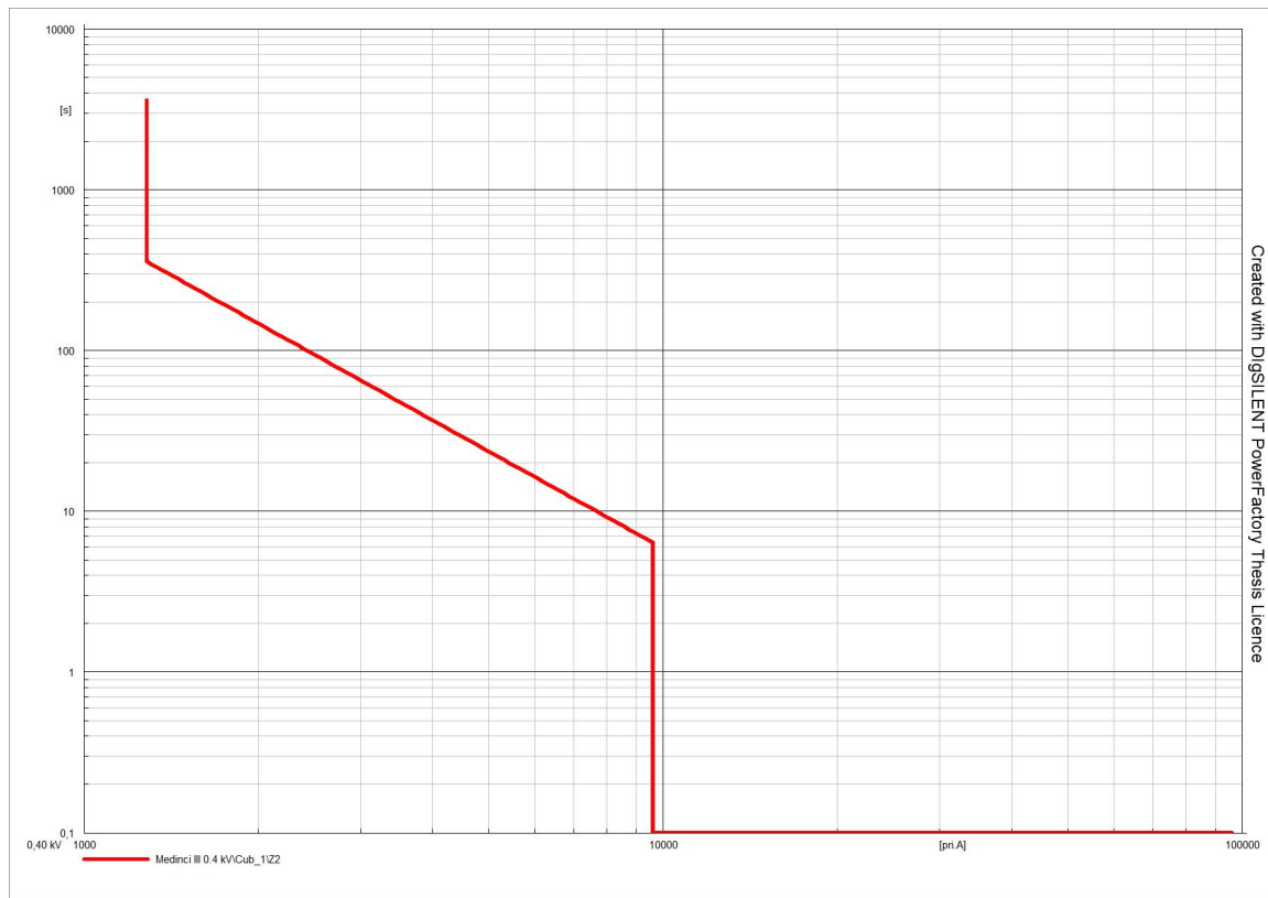
Slika 5.10. t-I karakteristika Setron ETU25B prekidača
