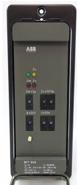
Slika 5.2. Prikaz ABB releja
