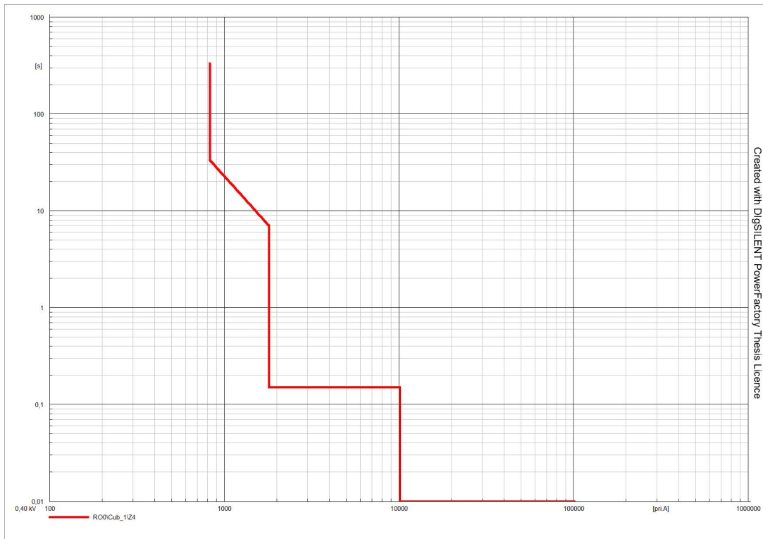
Slika 5.8. t-I karakteristika Terasaki niskonaponskog prekidača
