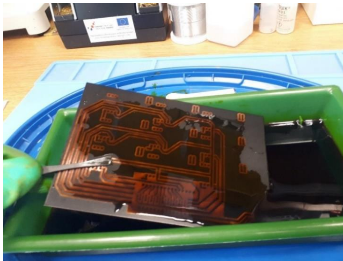
Slika 3.6. Postupak skidanja bakar pomoću feriklorid kiseline
