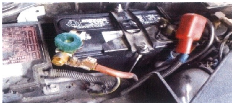
Slika 3.3.1. Ugradnja prekidača za automobilski akumulator
