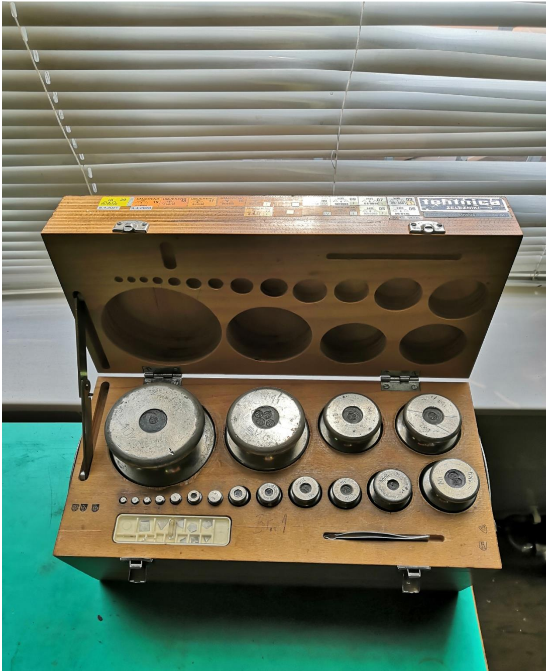
Slika 6.1. Utezi razreda točnosti M1
