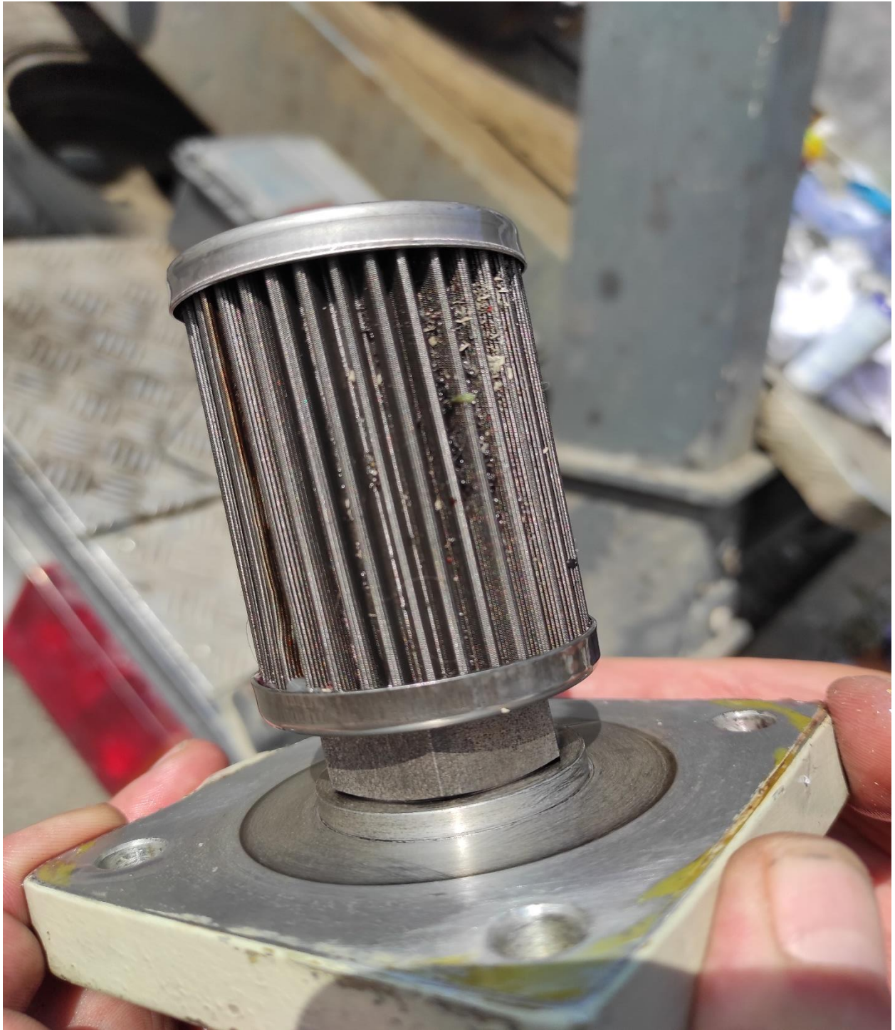
Slika 5.7. Zamjena filtera ulja
