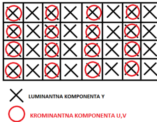
Slika 3.4. Shema poduzorkovanja YUV 4:2:2
