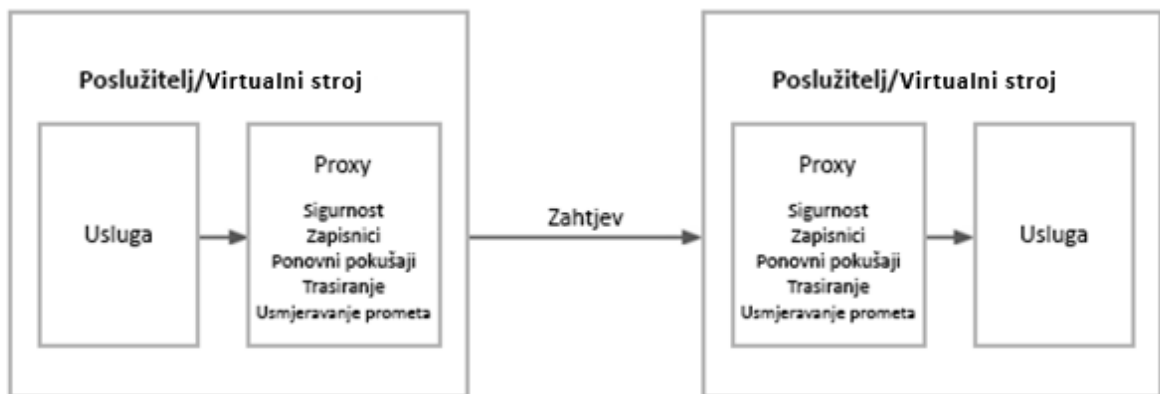
Sl. 3.5 Prikaz korištenja proxya unutar mreže usluga [12].
