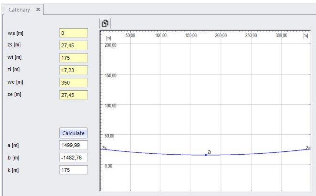
Slika 5.4. Izračun provjesa vodiča dalekovoda
