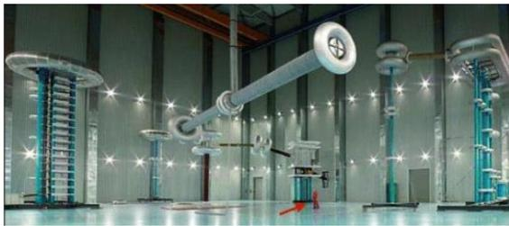
Slika 4.2. Toroidna elektroda [1]
