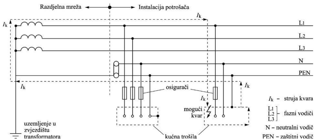
Slika 5.2.. Shematski prikaz uzemljenja elektroenergetskog sustava [4]
