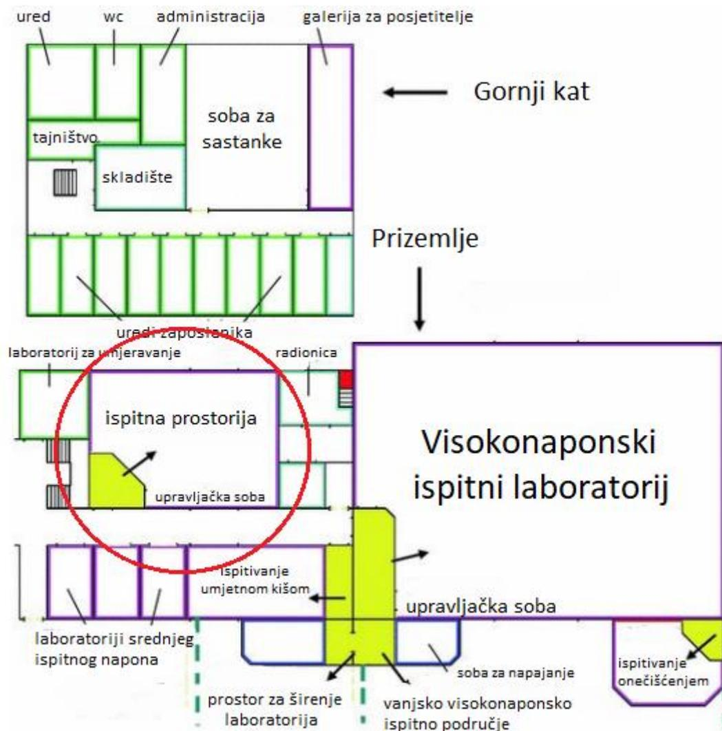
Slika 6.1. Tlocrt poslovnog prostora za visokonaponska testiranja
