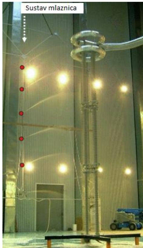
Slika 6.3.. Ispitivanje pomoću umjetne kiše [1]
