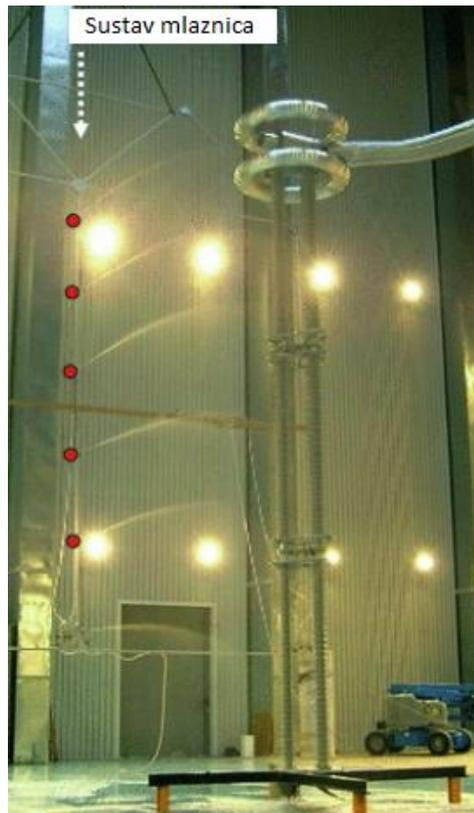
Slika 6.3.. Ispitivanje pomoću umjetne kiše [1]
