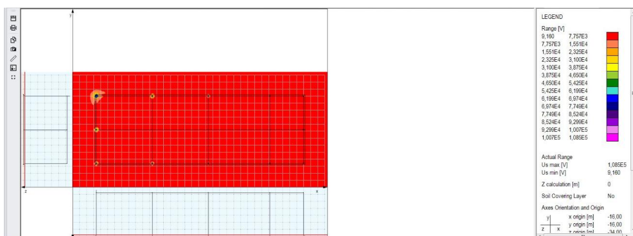
Slika 5.34: 2D prikaz napona koraka za 1. negativni impuls
