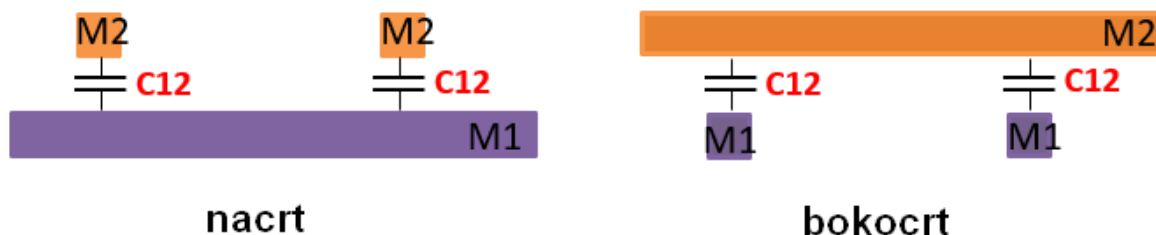
Slika 4.1. Parazitni kapaciteti među slojevima [23]
