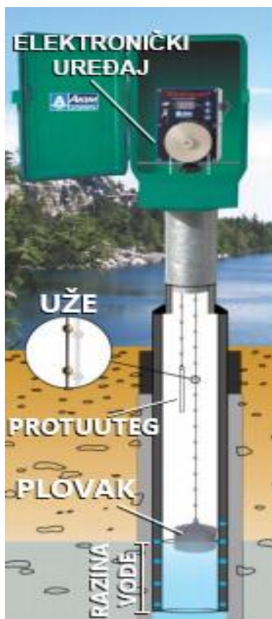
Slika 3.1.1. Princip rada i dijelovi elektroničkog limnigrafa s plovkom [14]
