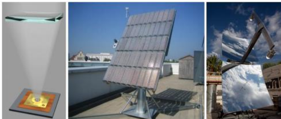
Slika 3.9. Dva uzorka korištenja Fresnelovih leća i uzorak korištenja ogledala kao koncentrirane optike [11]
