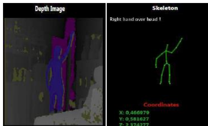
Slika 2.4. Prikaz prepoznavanja geste ruke iznad glave putem Kinect senzora
