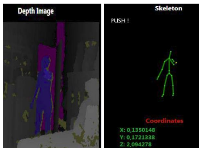
Slika 2.5. Prikaz prepoznavanja geste guranja putem Kinect senzora
