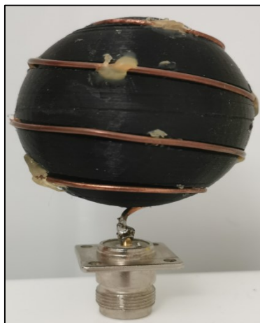
Sl. 3.6. Izvedba loksodromske antene sa podlogom (D=6cm, N=4cm)
