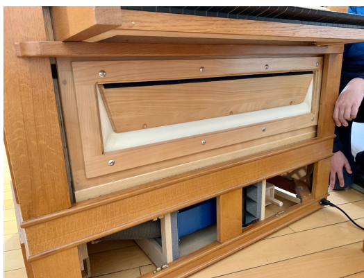
Slika P.2.4. Pogled na zračnicu s pomičnom membranom u ulozi mijeha i komore sustava dovoda zraka s izlaznom komorom i zvučnom izolacijom
