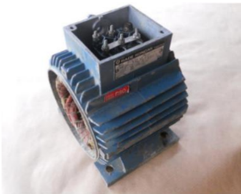
Slika 2.1. Stator i priključna kutija trofaznog asinkronog kaveznog motora [2]
