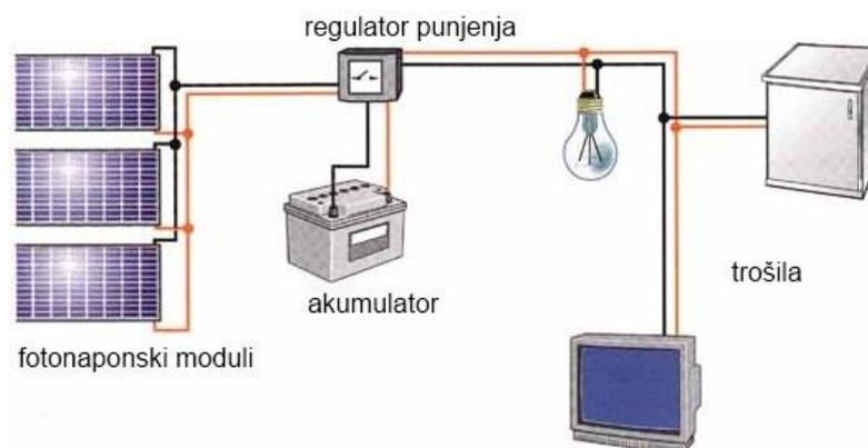
**Slika 2.5.** Prikaz fotonaponskog sustava [8]
