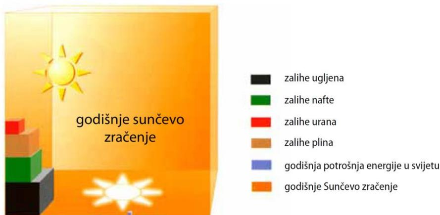
**Slika 2.1.** Godišnje sunčevo zračenje na površinu Zemlje u usporedbi sa zalihama ostale ukupne proizvedene energije u svijetu [2]
