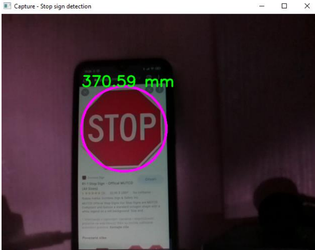
Slika 3.20 Obradana slika gdje je prepoznat objekt te udaljenost od istog
