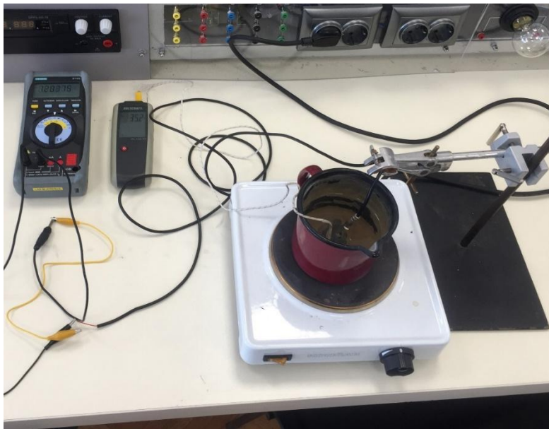
Slika 4.9. Mjerni postav prilikom mjerenja Pt100 sondom
