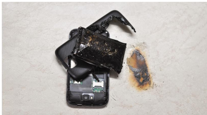
Slika 3.6. Posljedice pregrijavanja i eksplozije litij-ionske baterije
