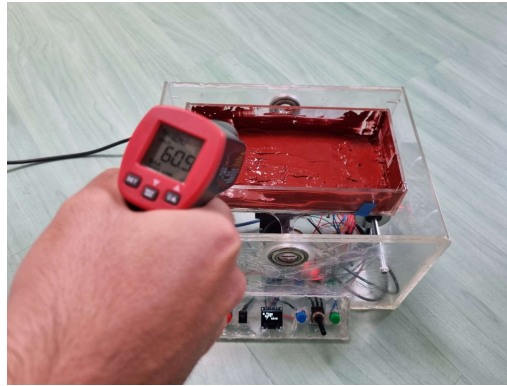
Sl. 4.5. Prikaz temperature na dnu posude
