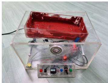
Sl. 4.3. Tresilica zakreće posudicu u desno
