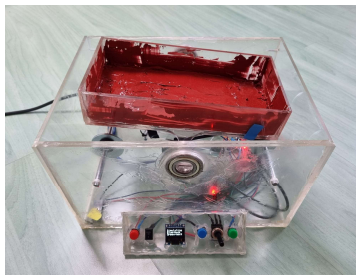
Sl. 4.3. Tresilica zakreće posudicu u desno
