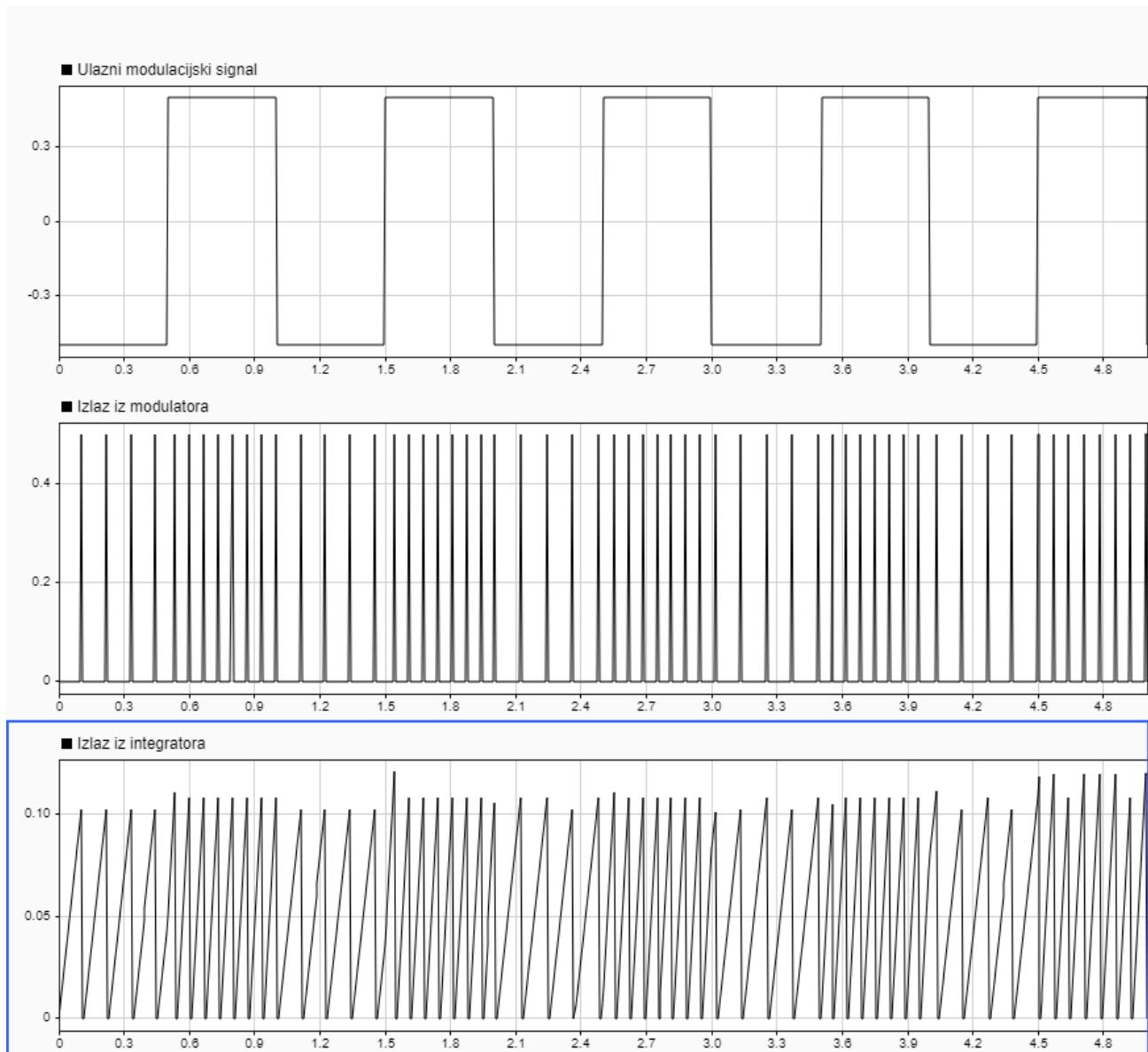
**Slika 4.4.** Uzni modulacijski signal, izlaz iz modulatora te izlaz iz integratora ako je ulaz x pravokutni signal za shemu sa slike 4.1.
