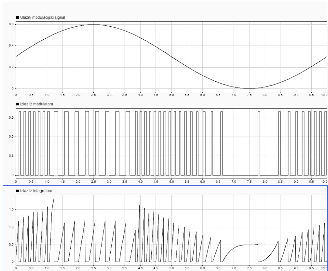
**Slika 4.11.** Ulagani modulacijski signal, izlaz iz modulatora te izlaz iz integratora ako je ulaz unipolarni sinusni signal frekvencije  $f = 0.1 \text{ Hz}$ , amplitude  $A = 0.3 \text{ V}$  za shemu sa slike 4.6.
