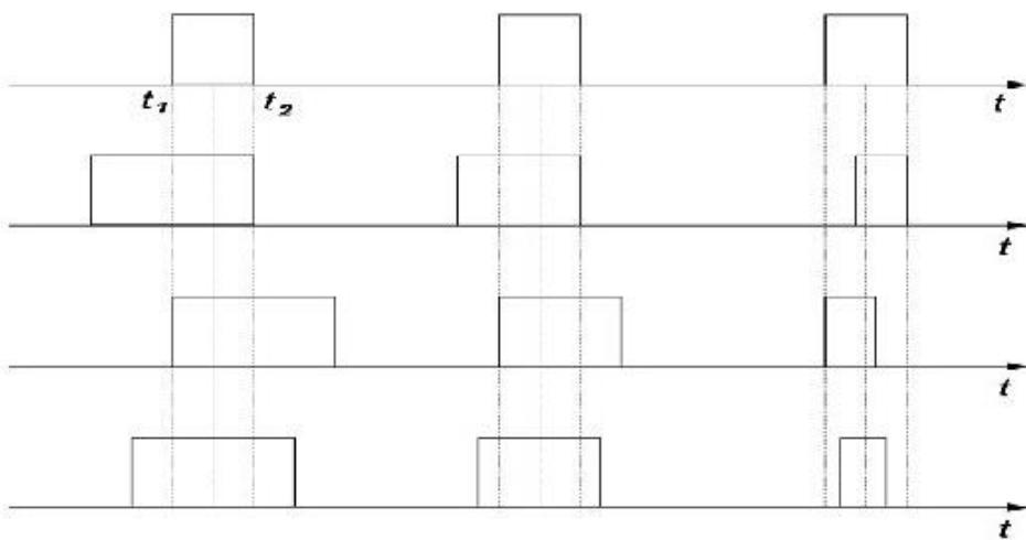
*Slika 2.5. Generiranje PPM impulsa pomoću PWM impulsa: a) nemodulirani nositelj; b) PPM s promjenom prednjeg brida impulsa; c) PPM s promjenom zadnjeg brida impulsa; d) PPM s promjenom prednjeg i zadnjeg brida impulsa [5]*
