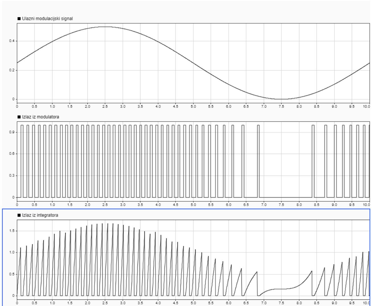
**Slika 4.9.** Uzlazni modulacijski signal, izlaz iz modulatora te izlaz iz integratora ako je ulaz unipolarni sinusni signal frekvencije  $f = 0.1 \text{ Hz}$ , amplitude  $A = 0.25 \text{ V}$  za shemu sa slike 4.6. Signal je pomaknut za vrijednost 0.25.
