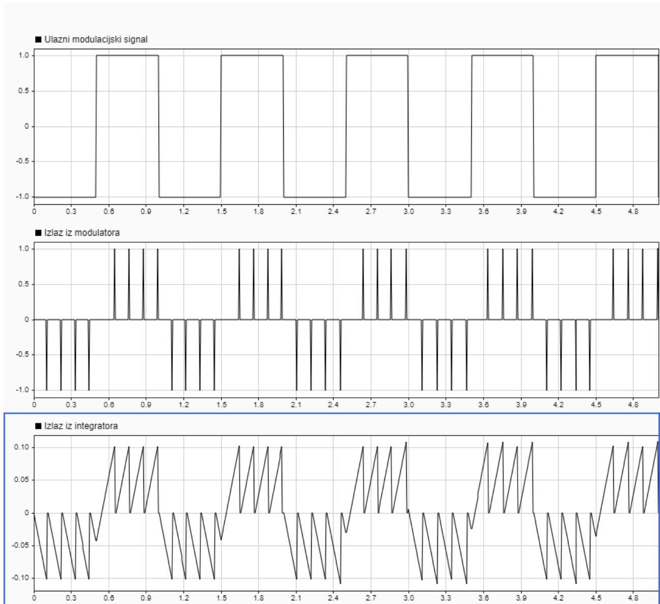
**Slika 4.3.** Ulagni modulacijski signal, izlaz iz modulatora te izlaz iz integratora ako je ulaz x pravokutni signal za shemu sa slike 4.1.
