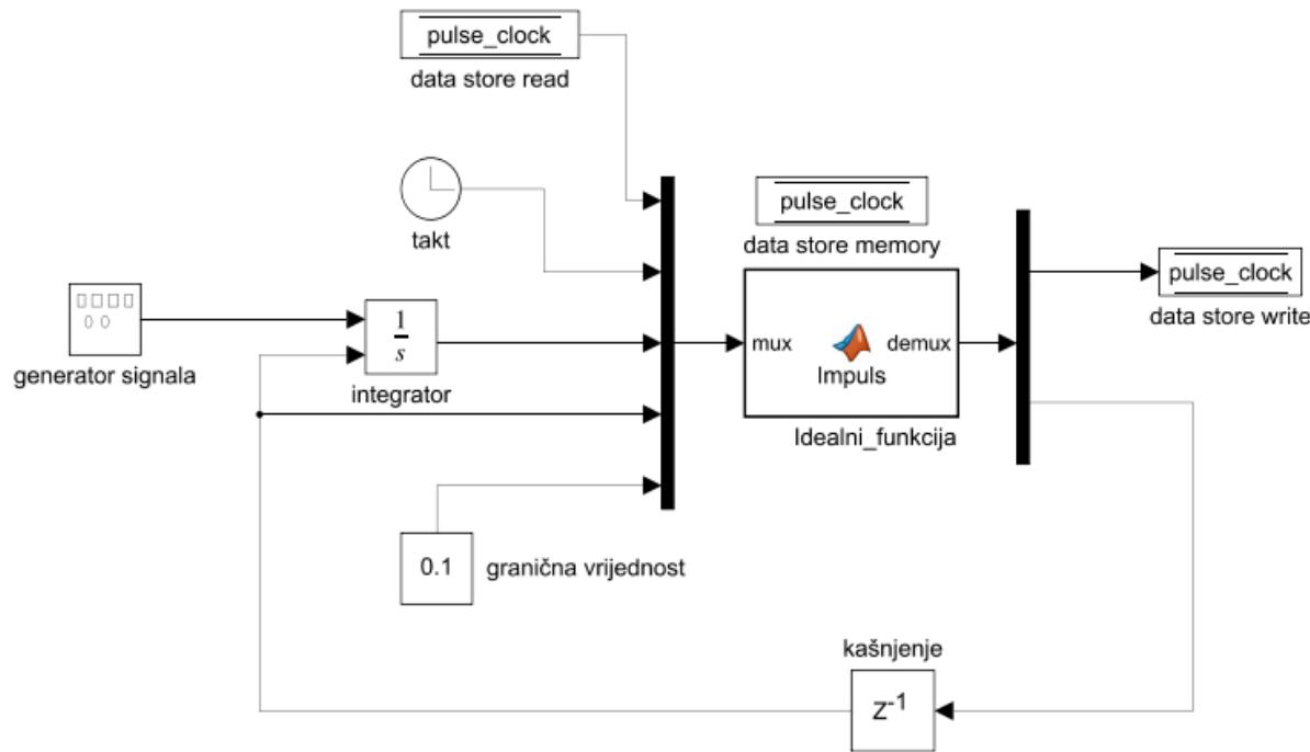
**Slika 4.1.** Blokovska shema idealnog integralnog impulsno frekvencijskog modulatora
