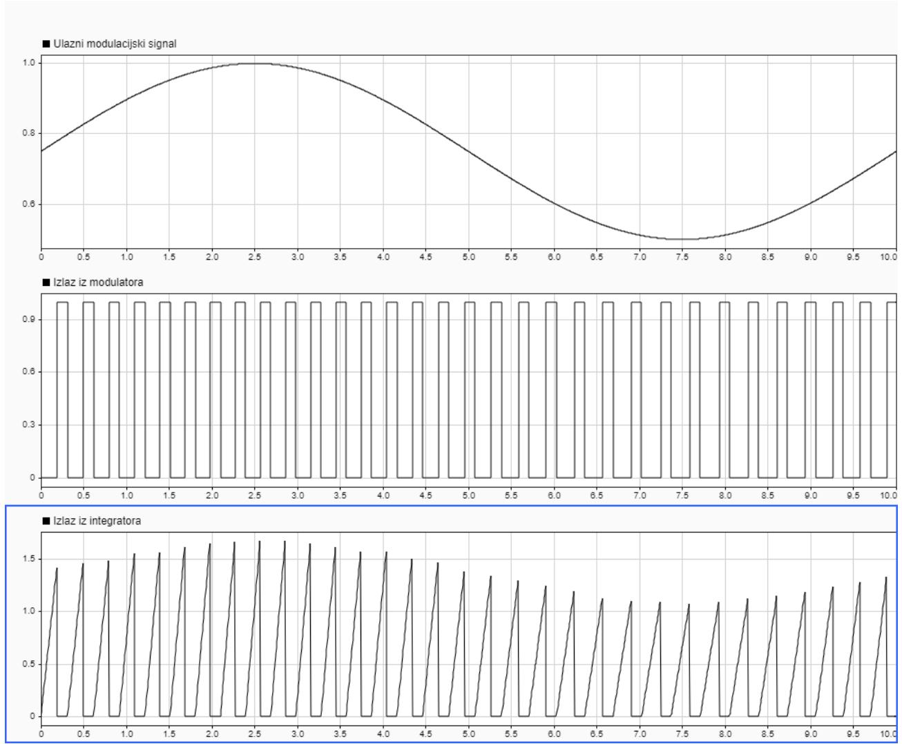
**Slika 4.10.** Ulagni modulacijski signal, izlaz iz modulatora te izlaz iz integratora ako je ulaz unipolarni sinusni signal frekvencije  $f = 0.1 \text{ Hz}$ , amplitude  $A = 0.25 \text{ V}$  za shemu sa slike 4.6.
