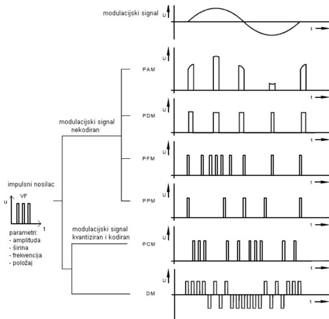
*Slika 2.2. Valni oblici modulacija impulsnih signala [3, str 62.]*
