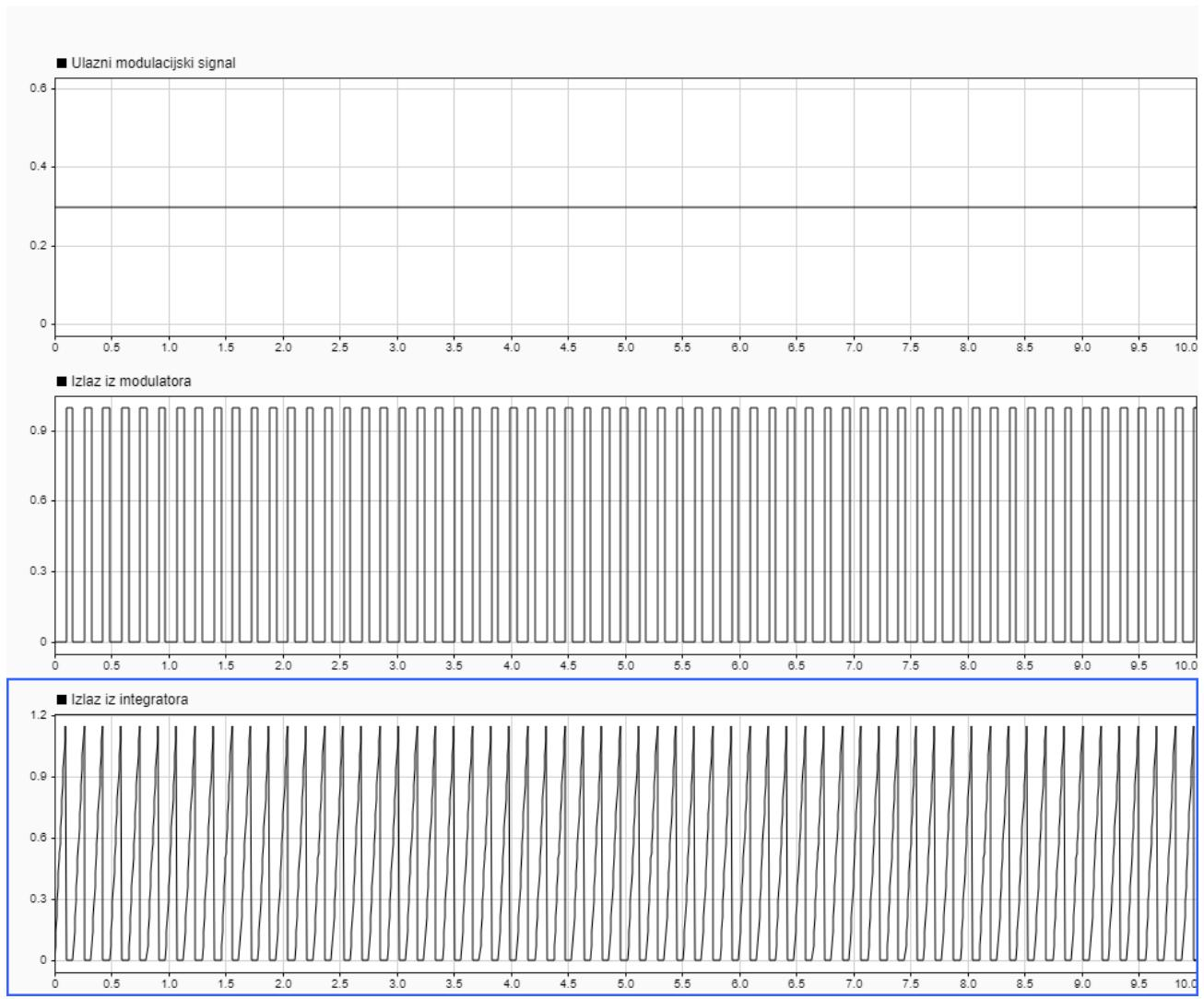
**Slika 4.7.** Ulagni modulacijski signal, izlaz iz modulatora te izlaz iz integratora ako je ulaz konstantni izvor napona amplitude  $A = 0.3 \text{ V}$  za shemu sa slike 4.6.
