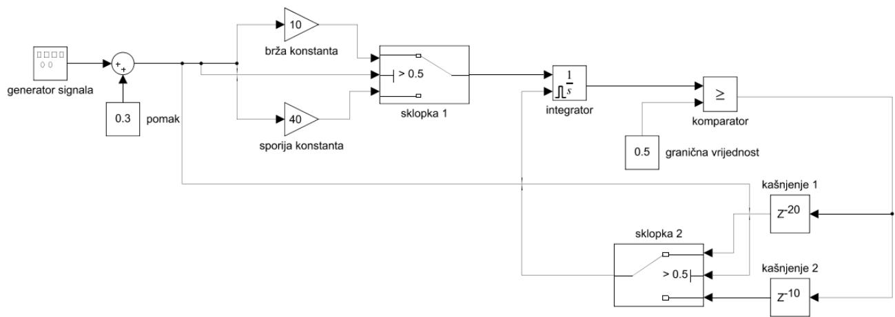
**Slika 4.6.** Blokovska shema adaptivnog integralnog impulsno frekvencijskog modulatora
