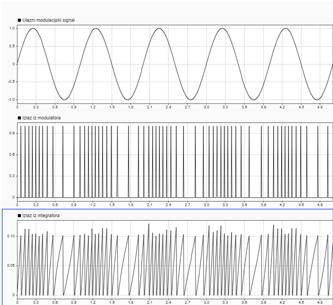
**Slika 4.5.** Uzni modulacijski signal, izlaz iz modulatora te izlaz iz integratora ako je ulaz x sinusoidni signal frekvencije  $f = 1 \text{ Hz}$ , amplitude  $A = 1 \text{ V}$  za shemu sa slike 4.1.
