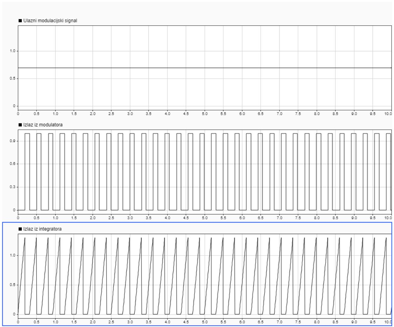
**Slika 4.8.** Ulagni modulacijski signal, izlaz iz modulatora te izlaz iz integratora ako je ulaz konstantni izvor napona amplitude  $A = 0.7 \text{ V}$  za shemu sa slike 4.6.
