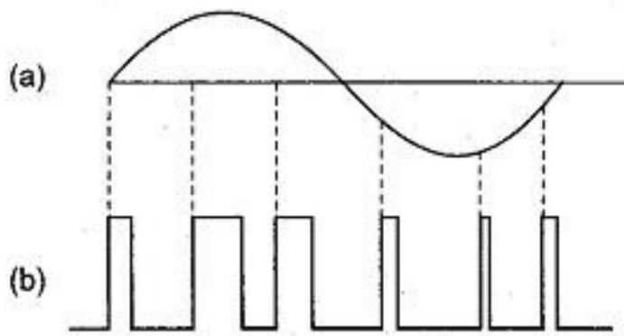
*Slika 2.4. Valni oblik: a) modulacijskog signala; b) PWM signala [4]*
