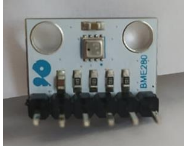
Slika 2.3. BME280 senzor za temperaturu zraka i vlagu
