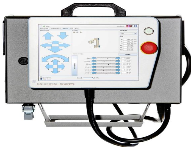
Slika 2.4. Zaslón na dodir s grafičkim okruženjem Polyscope
