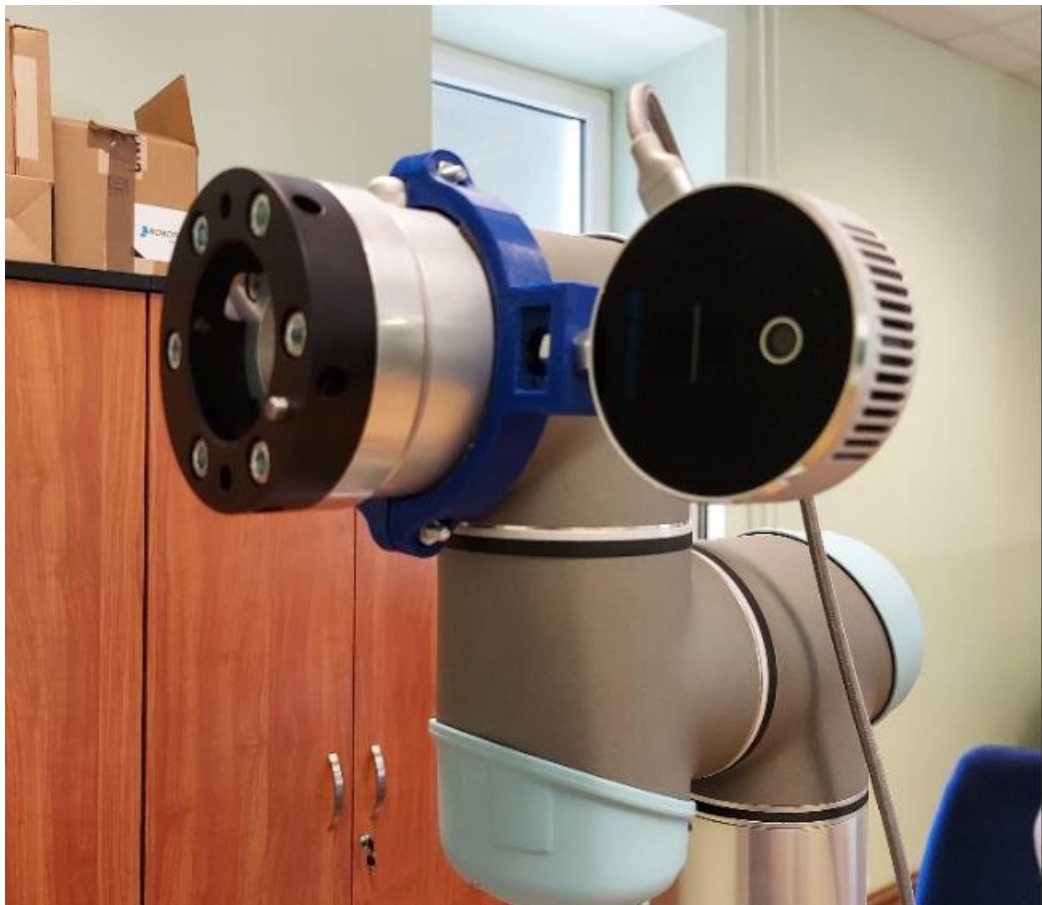
Slika 2.6. Intel RealSense™ LiDAR CAMERA L515
